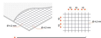
**DETALHE PISO EM CONCRETO ARMADO**
