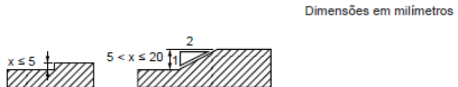
Figura 68 – Tratamento de desníveis
