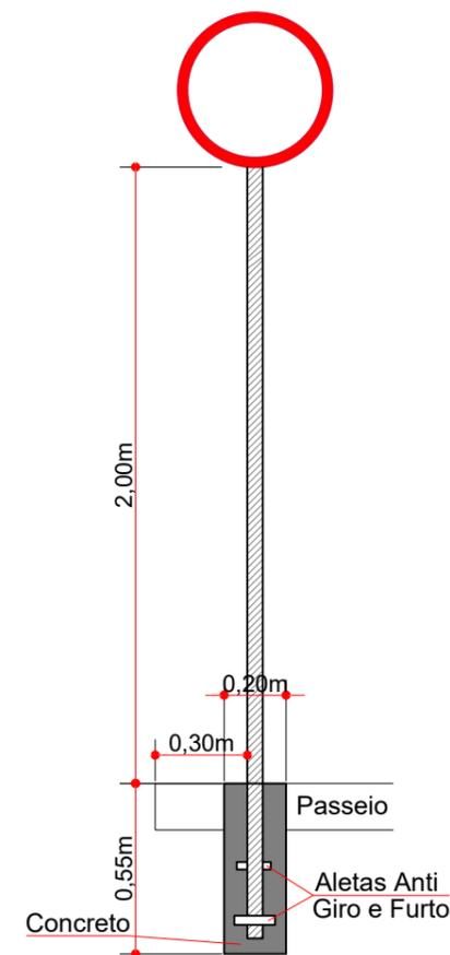
DETALHE DA FIXAÇÃO DE PLACAS
