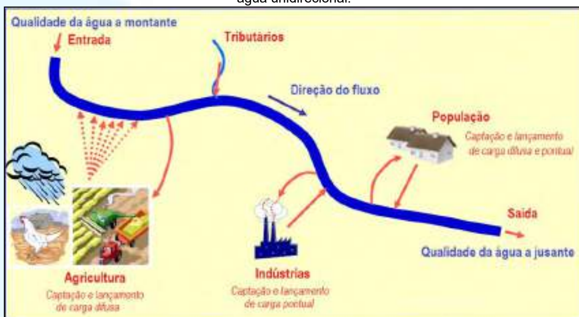
Figura 612 - Captações e descargas de efluentes a serem simulados em modelos de qualidade de água unidirecional.
