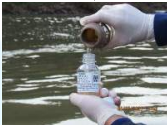
Figura 539. Acondicionamento da amostra da comunidade zooplanctônica.
