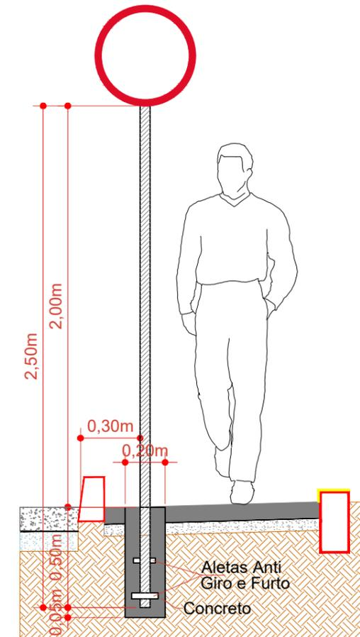
Detalhe da Fixação de Placas
